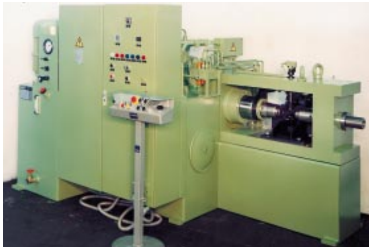
13. Waagrecht-Montagepresse mit Automation, 630 kN
