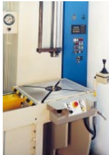
5. Einständerpresse umschaltbar auf Handhebelsteuerung und Schiebetisch, 160 kN
