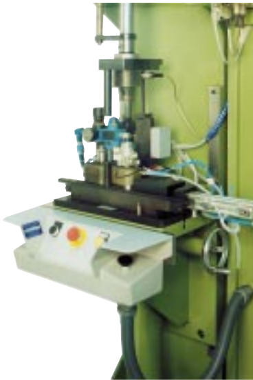
9. Einständerpresse mit verstellbarem Tisch, 40 kN
